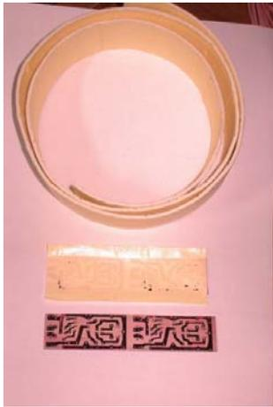
重新來過，這次，背膠用雙面紙貼在 A4 紙上，並且貼的位置避開電路基板的範圍，列印完成後，用美工刀割離 A4 紙即可，（其實，你要有整張的熱轉印紙，大可不必這麼麻煩）然後，將印有水平鏡射電路的背膠壓在電木板上，（如果怕錯位的話，可以用膠帶固定背膠和電木板的相對位置。）用熨斗來回熨個幾次，等到冷了以後，就可以脫膜。脫膜慢慢的即可，撕下來以後，就像照片裡的一樣，由於背膠不平整（原本是捲成一團的），有許多皺折，這些皺折處，轉印、脫墨都不良，要使用油漆筆稍微補一下。沒有皺折的地方，其實轉印的不錯，1 公釐的小型字也是 OK 的。
