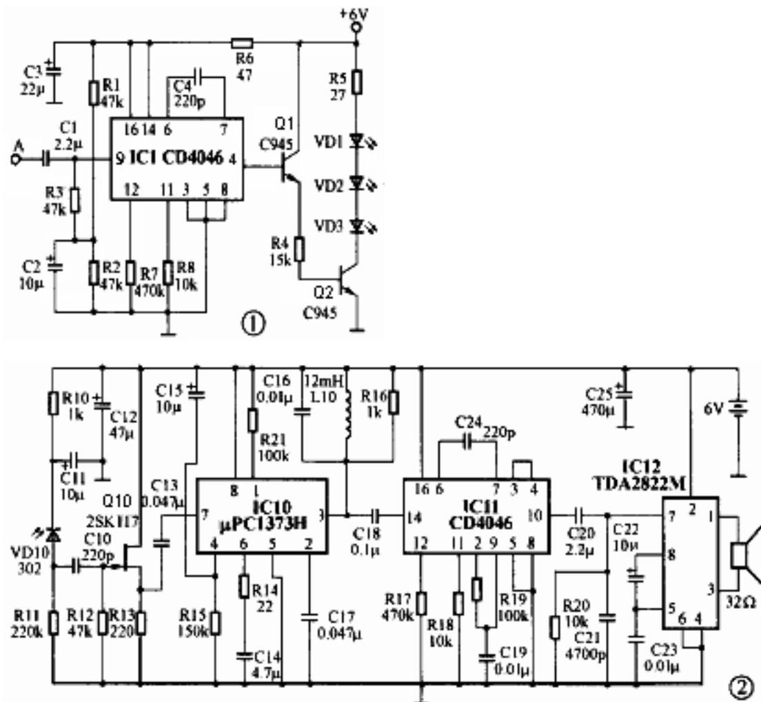
圖 1 中的三極管 Q1 與 Q2 用來驅動紅外 LED，如果沒有相同型號，也可用常見的 C1815 或 9014 代替，但管子的 β 值最好取得偏大一點。
