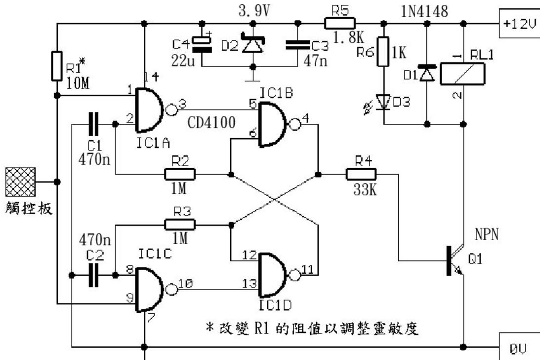
這是一個簡單的電路可以觸控的方式開啓、關閉繼電器(RL1)，接觸板使用一片小小的金屬片，當 D3 LED 亮起時青示繼電器動作，電源供應使用 12V，但經過 R5 及 D2 ZINER 降壓至 3.9V 以供應 CMOS IC 的電源，若復位不正常時可調整 R1 的電阻值。
