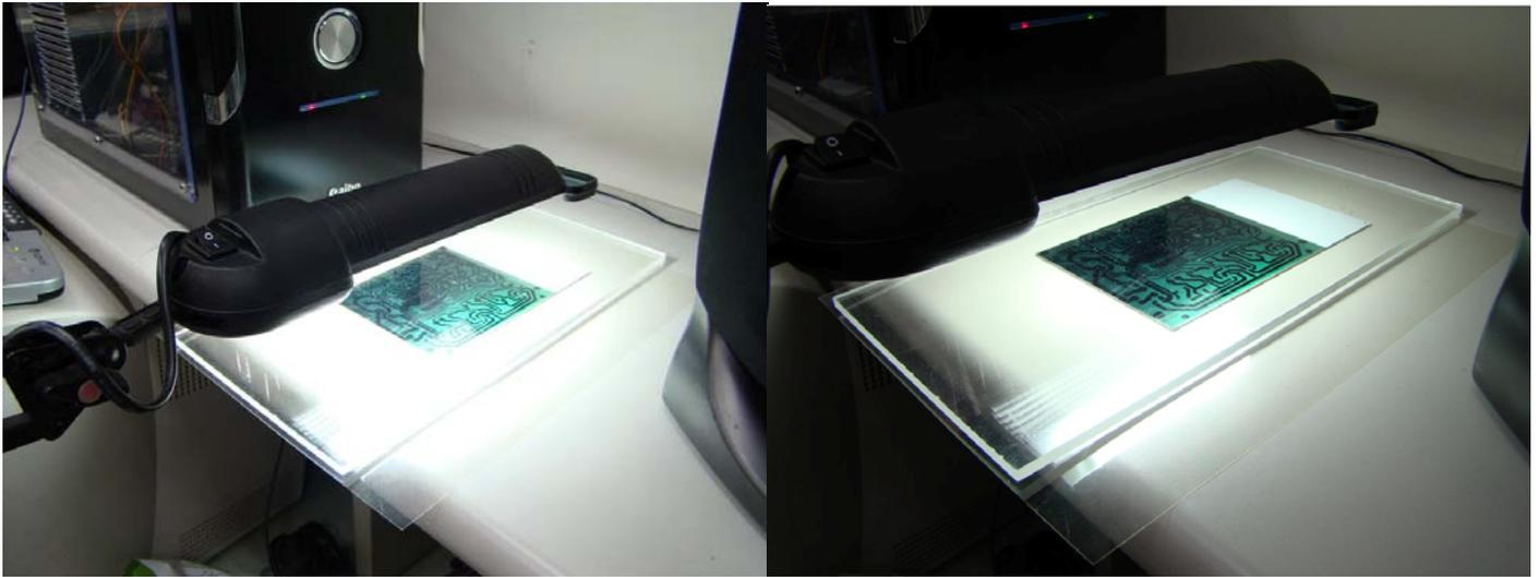
曝光的話只要有紫外線的光源都可以曝光，但時間我就要依個人經驗衡量了，一般我在曝光時若使用專用紫外線曝光機，則需要 90-120 秒左右，不過那是學校所有的不是每次都可以借到，因此我大部分用檯燈曝光，時間大約抓在 9-12 分鐘左右，然後檯燈不可以離感光板太近也不能太遠，大約在 5-10 公分上下。想起自己剛學洗板子時，怎樣都曝光失敗，最後才發現，光源離板子太近了。但要是太遠的話，紫外線不足，因此可能要拉長時間，這我也無法詳細計算出要增加多久，所以還是將範圍設定在 5-10 公分就好。
