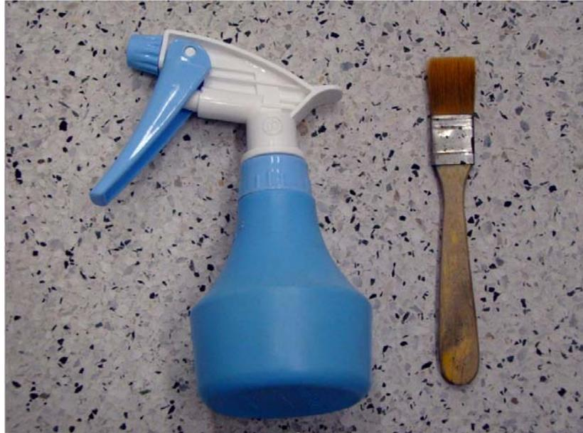
噴槍與軟毛刷：噴槍裡面裝的是顯像液，軟毛刷是用來在顯像時幫助反應用的。顯像液也需要調配，我自己的使用方法是，先將顯像液調配好(※1：20 的比例)，然後拿一個大的保特瓶裝起來，因為顯像液會與空氣反應而失效，之後再將一部分的顯像液溶液倒入噴槍，其餘放置陰暗處存放(需蓋緊蓋子)。這樣做的目的是為了節省顯像液的使用。說明書上將溶液調配好之後放在塑膠盆即可顯像，但這樣一來蝕刻液接觸空氣面積大，隔天那些顯像液可能就無法反應了，另外用噴的也可以將較細部的電路顯像出來，這是我的經驗提供大家參考。
